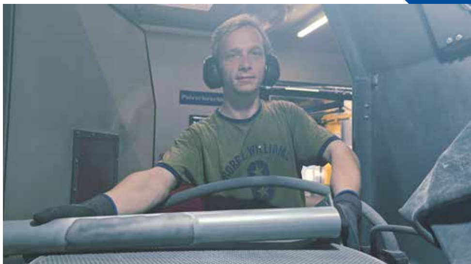
Merlin Nienhaus bearbeitet die Werkstücke mit Kunststoffstrahlmittel in der Druckstrahlkabine.
