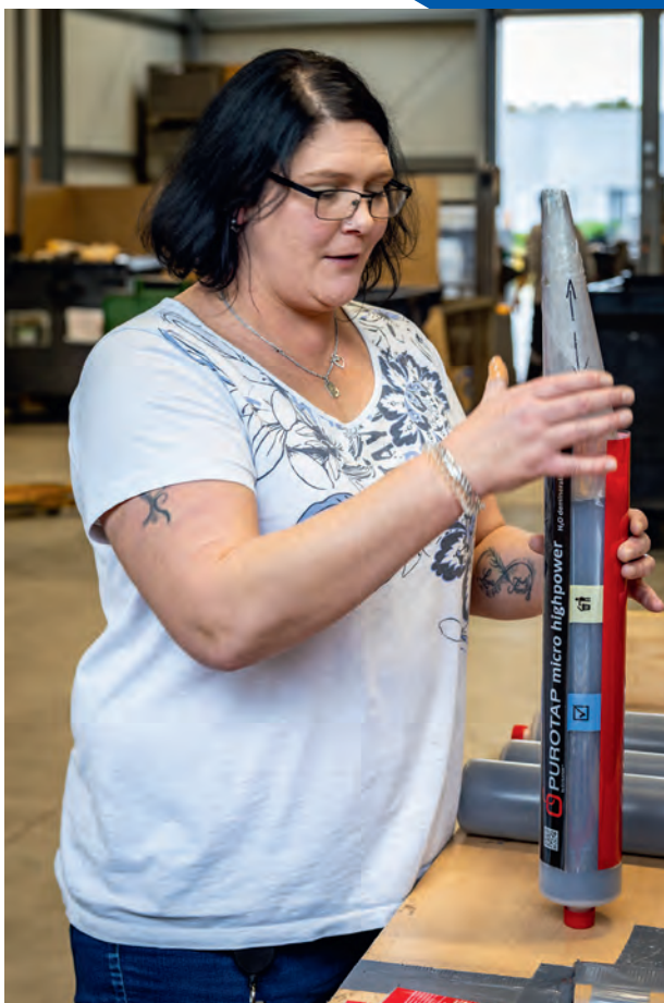
Jessica Heinemann stülpt einen Sleeve über die Entsalzungspatrone.
